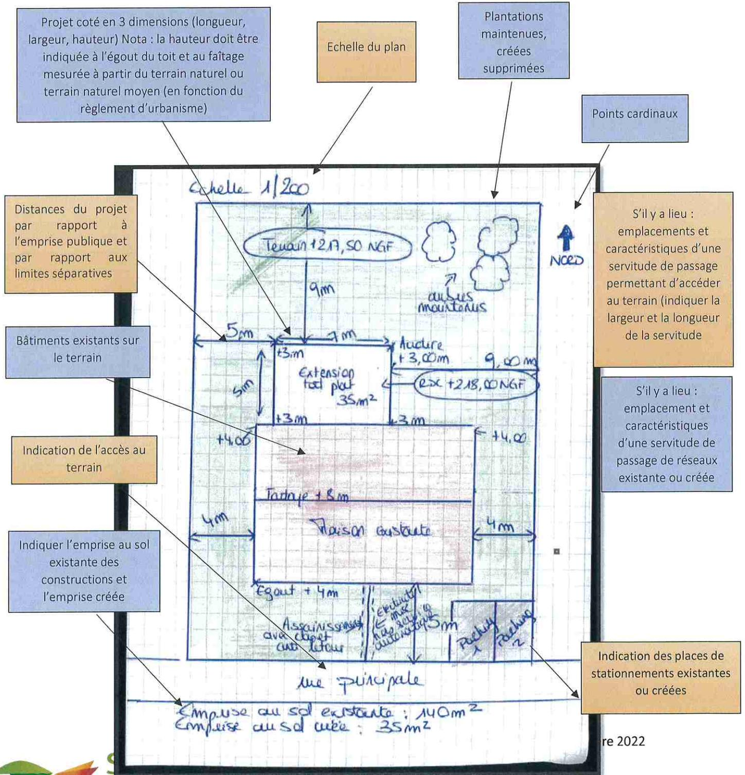
Projet coté en 3 dimensions (longueur, largeur, hauteur) Nota : la hauteur doit être indiquée à l'égout du toit et au faîtage mesurée à partir du terrain naturel ou terrain naturel moyen (en fonction du règlement d'urbanisme)
